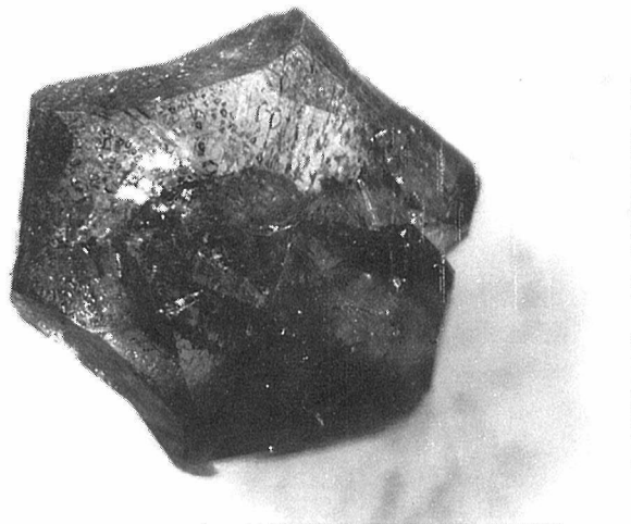
立方晶窒化ほう素単結晶 (最大幅 3mm 厚さ 1mm)
