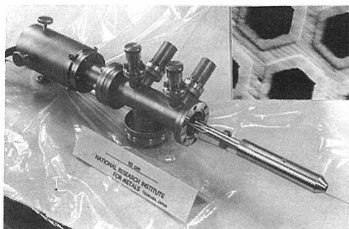
当研究所が開発した小型集束イオン銃と、銅網（穴径約 45 \mu\text{m} ）を照射したときの二次電子像
